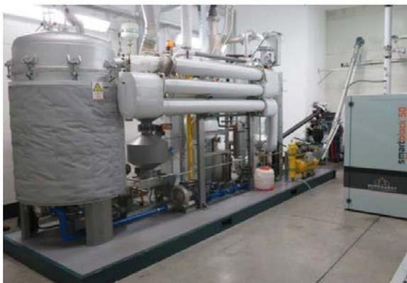
新製品：V4.50(50kW)ガス化炉の全容
